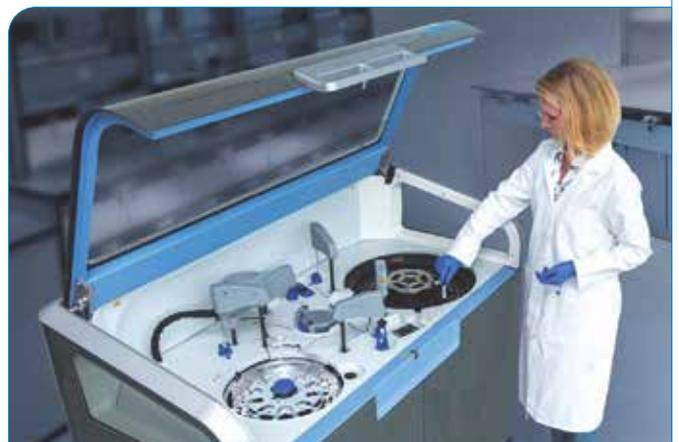
Cet instrument hautement automatisé avec une capacité opérationnelle complète fonctionne avec des réactifs liquides prêts à l'emploi permettant des tailles de lots beaucoup plus importantes.
