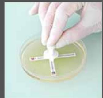
Le dispositif permet de déposer en une seule manipulation, facilement et sans erreur les bandelettes sur la surface d'agar.
