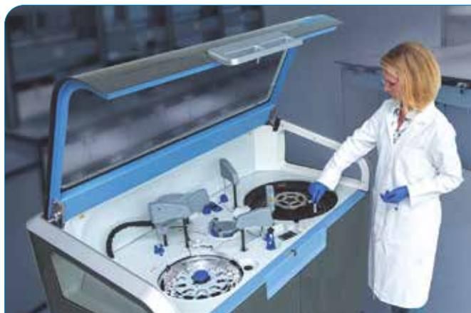
Cet instrument hautement automatisé avec une capacité opérationnelle complète fonctionne avec des réactifs liquides prêts à l'emploi permettant des tailles de lots beaucoup plus importantes.
